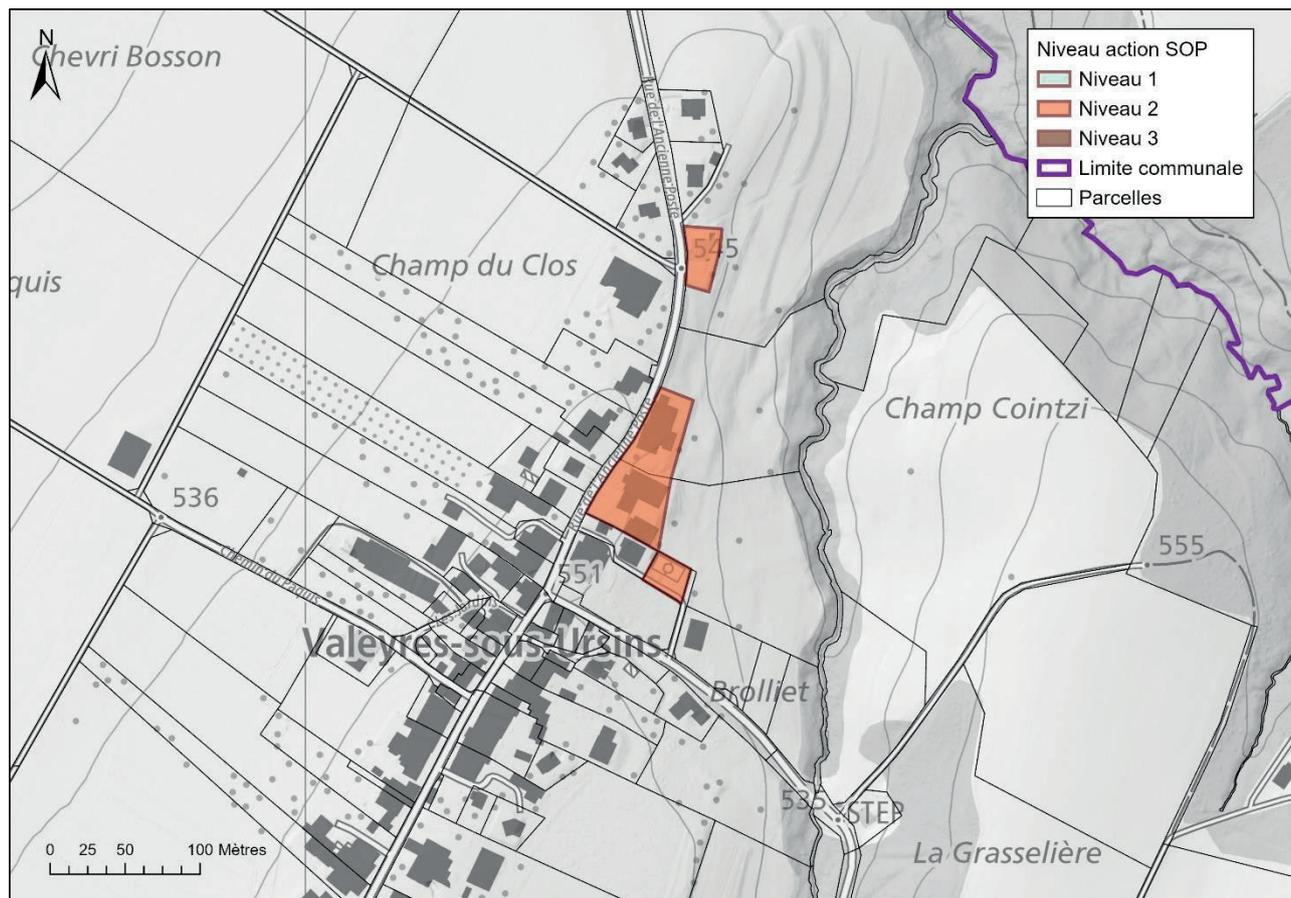
Figure 4 : Niveau d'action pour les zones constructibles des parcelles exposées aux dangers naturels de glissements profonds permanents dans la commune de Valeyres-sous-Ursins.
